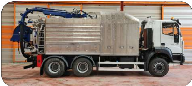
Emiş Hortumu Saklama Tamburu Suction-Storage Hose Reel
